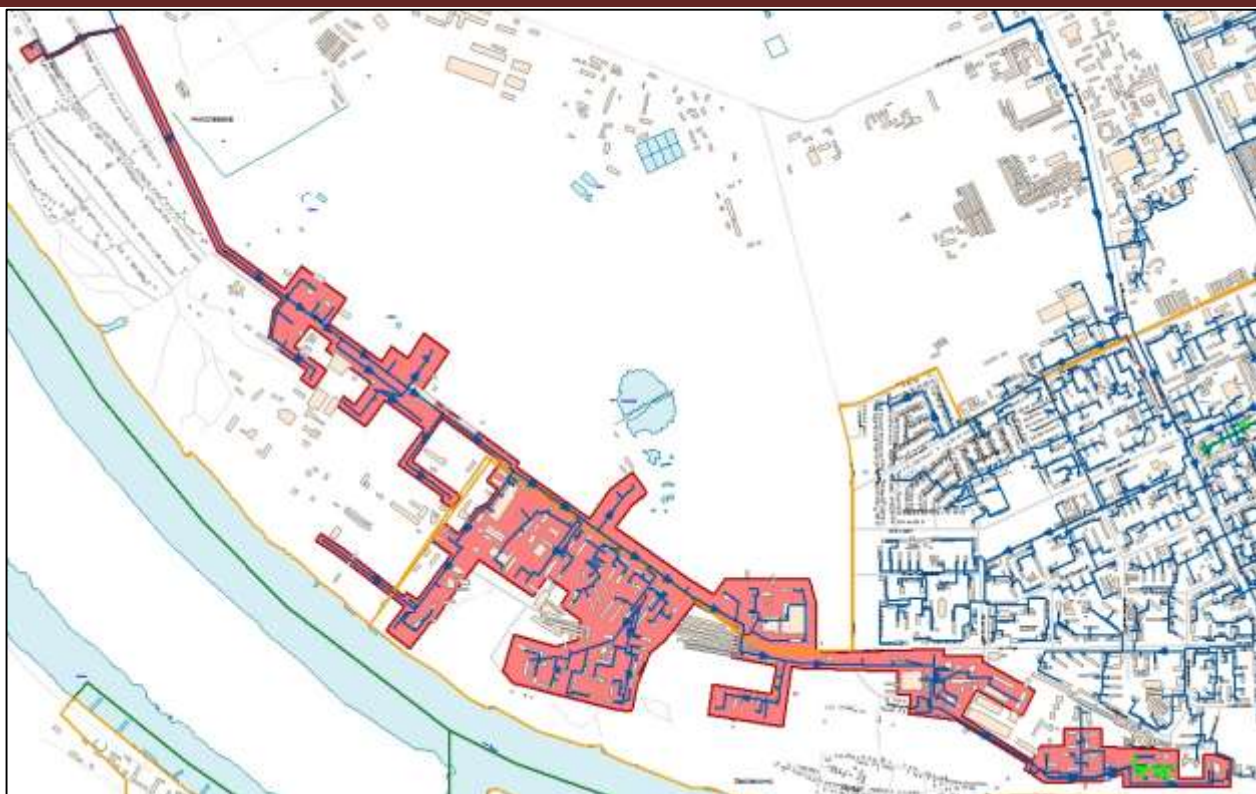
Рисунок 1.1 – ТЭЦ-4, зона теплоснабжения с ненормативными показателями надежности, участок от Уз-IV-I-7 и далее по направлению.
