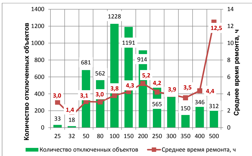
Рисунок 1.14. Соотношение среднего времени на аварийно-восстановительные работы к количеству отключенных зданий в отопительный период 2014-15гг
