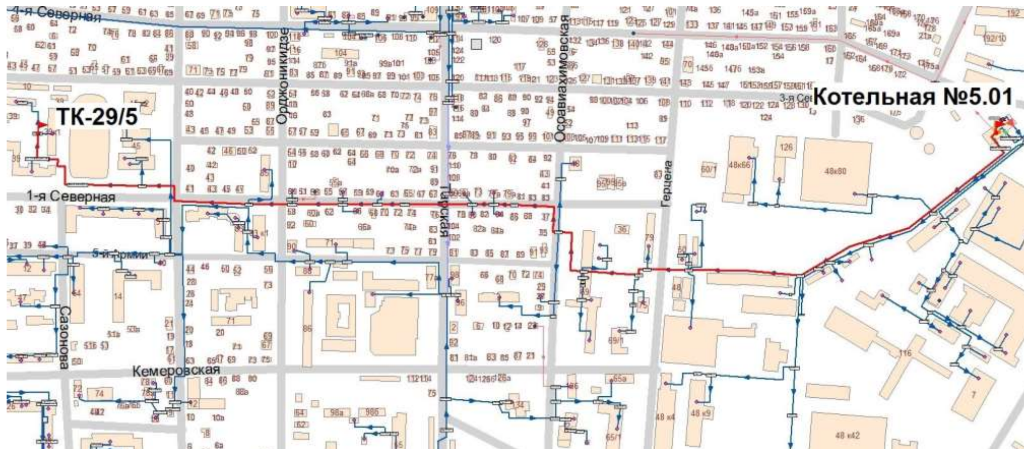
Рисунок 5.33. Трассировка теплопровода от Котельной 5.01 до ТК-29/5
