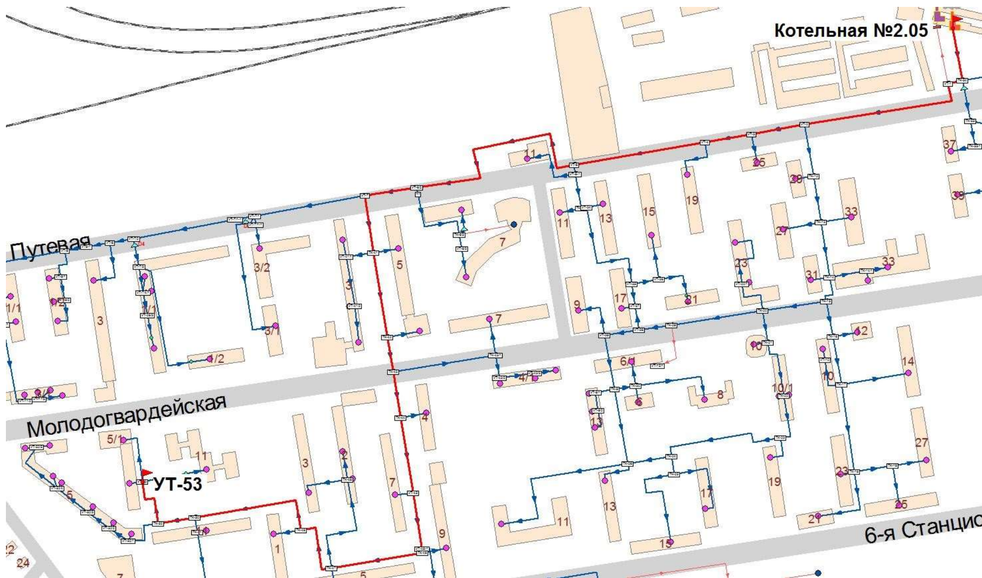
Рисунок 5.19. Трассировка теплопровода от Котельной 2.05 до УТ-53
