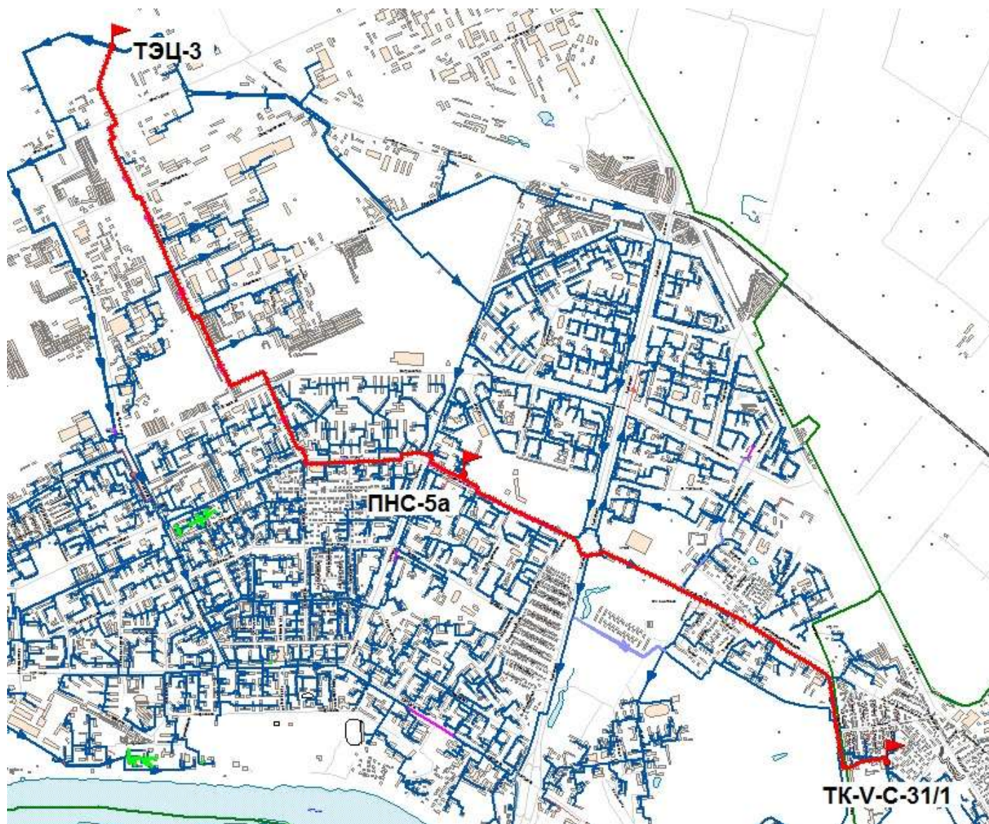
Рисунок 4.23 Трассировка теплопровода «ТЭЦ-3 → ТК-V-C-31/1»
