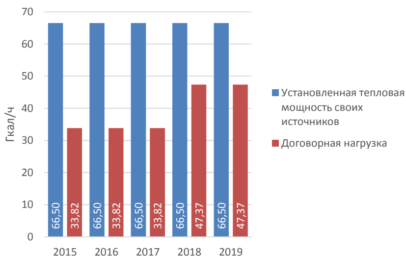
Рисунок 10.47. Установленная мощность котельной ООО «Тепловая компания» и договорная нагрузка за 2015-2019 гг.
