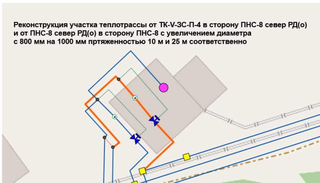
Рисунок 32. Схема трассировки участка теплотрассы от ТК-V-3С-П-4 в сторону ПНС-8 север РД(о) и от ПНС-8 север РД(о) в сторону ПНС-8 (отмечена оранжевым цветом)
