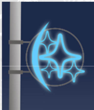
Размер световой композиции - 2020ммx2500мм Стандартный диаметр окружности - 2000мм
